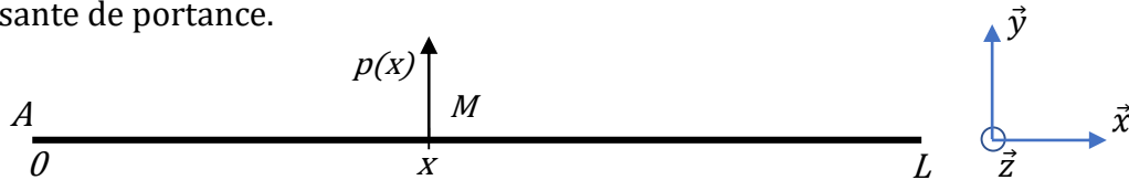
Figure 4 - Modélisation de l'aile dans son écoulement
