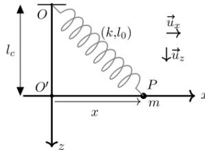
FIGURE 2 – Oscillateur horizontal
