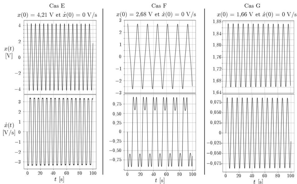
FIGURE 12 – Relevés expérimentaux pour trois conditions initiales différentes lorsque les paramètres du circuit de la figure 9 sont correctement réglés avec une résistance  $R_B$  placée en parallèle sur  $C_1$  et  $C_2$
