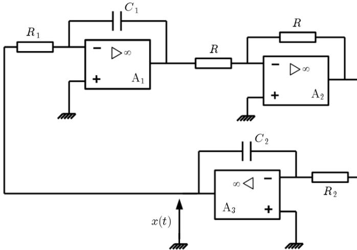
FIGURE 5 – Oscillateur électronique
