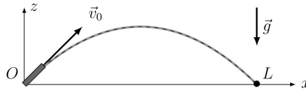
FIGURE 2 – Canon à eau en configuration de portée maximale
