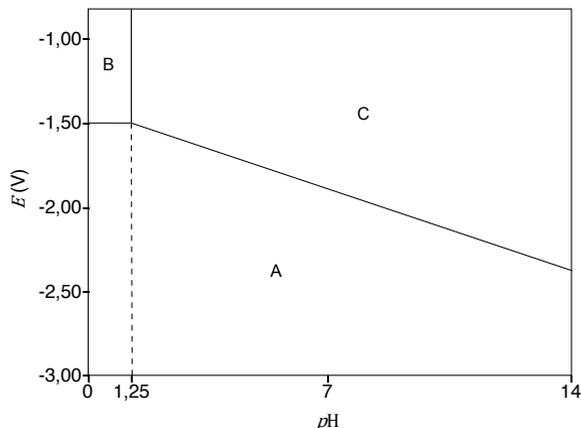
Le diagramme a été tracé à 298 K et sous 1 bar en solution aqueuse, en prenant les concentrations des espèces en solution égales à  $c_0$ .
