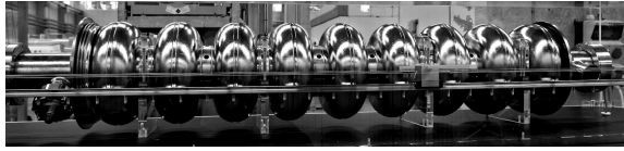
Figure 2 – Photographie montrant une cellule TESLA du XFEL européen. Source : wikipedia.
