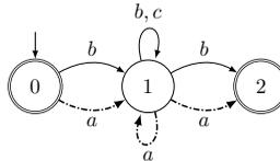
**Figure 5** – Un automate marqué  $\mathcal{A}_2^M$  sur  $\Sigma_3$ . Les états initiaux, ici seulement 0, sont indiqués par une flèche et les états terminaux, ici 0 et 2, sont doublement cerclés. Les transitions marquées, ici celles d'étiquette  $a$ , sont représentées par une ligne épaisse en traits et points.
