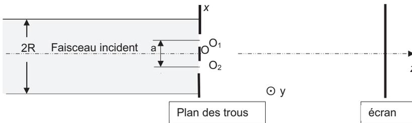
**Figure 2** - Géométrie du dispositif à deux trous
