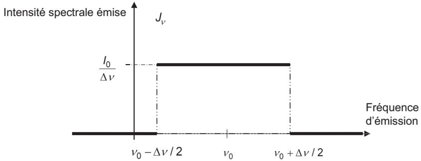
**Figure 3** - Profil "rectangulaire" d'une source quasi-monochromatique
