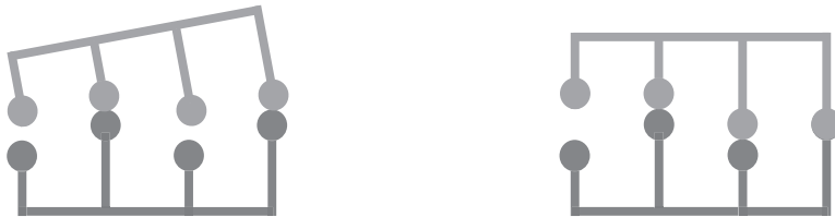
Figure 3 - Exemple de posages entre 2 pièces. À gauche : posage aux points 1 et 3. À droite : posage aux points 1 et 2 avec collision en 3
