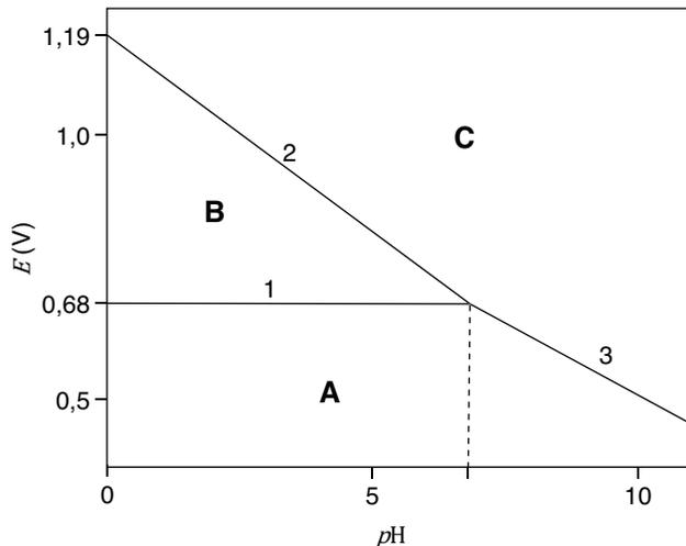
Figure 2. Diagramme potentiel-pH de quelques espèces de l'iode.
