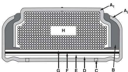
$A_1$  et  $A_2$  : revêtements métalliques, B : joint isolant, C : orifice d'entrée d'air, D : membrane semi-perméable, E : dioxygène (air), F : membrane hydrophobe, G : séparateur, H : poudre de zinc et électrolyte (solution gélifiée de potasse).
