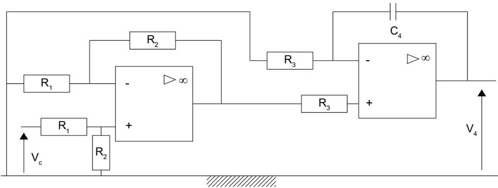
Figure 15 : montage électrique utilisé à la sortie du capteur à effet Hall.
