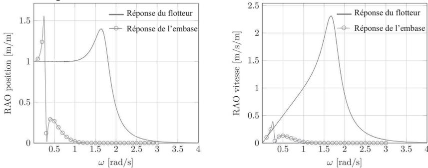
Figure 12 : RAO en amplitude et en vitesse pour l'houlogénérateur.
