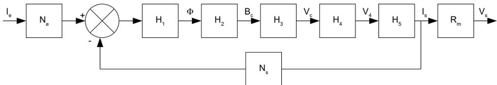
Figure 14 : Modélisation par schéma bloc de la mesure du courant. La fonction de transfert  $H_3(p)$  est une constante de valeur  $H_3(p) = K_3$ . On note  $B_c$  le champ magnétique dans le capteur à effet Hall.
