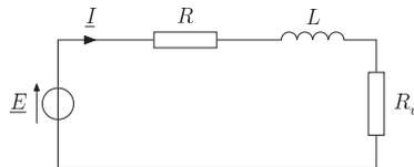
**Figure 9** Schéma électrique d'un enroulement statorique
