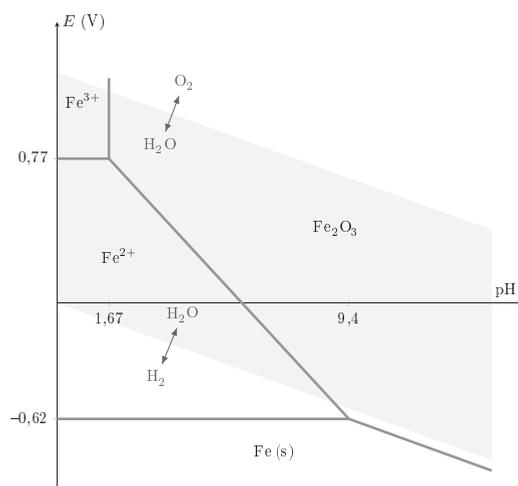
**Figure B** Diagramme E-pH du fer à la concentration  $C = 1 \times 10^{-6} \text{ mol.l}^{-1}$
