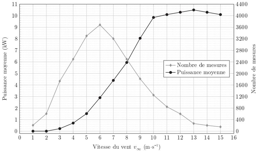
Figure 2 Mesures de contrôle sur site de l'éolienne FAIRWIND 10 kW.
