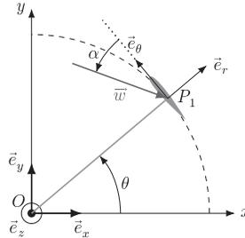
**Figure 4** Définition de l'angle d'attaque  $\alpha$
