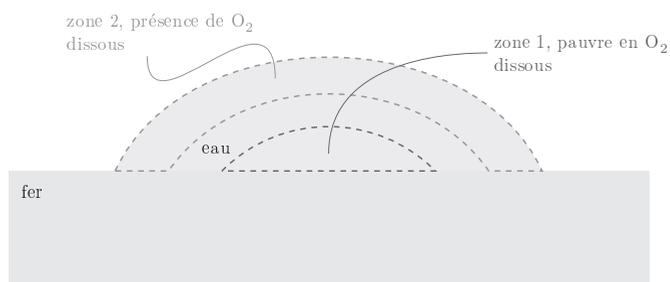
Figure C Corrosion différentielle du fer dans une goutte d'eau.
