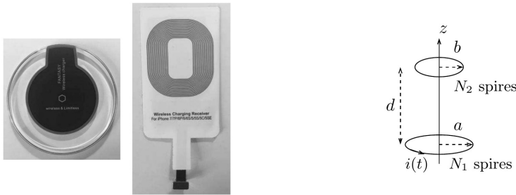
FIGURE 6 – À gauche : système de transmission classique (émetteur et récepteur) utilisé dans les chargeurs sans fil actuels. À droite : schéma et notations utilisées.
