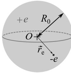
Figure 2 – Modèle simplifié d'atome. La partie grisée représente la charge  $+e$  délocalisée dans toute la sphère de rayon  $R_0$ . L'électron est représenté par une charge  $-e$  ponctuelle, de vecteur position  $\vec{r}_e$ .
