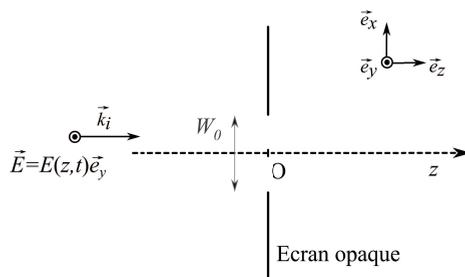
Figure 1 – Onde incidente sur l’ouverture ( $\mathcal{O}$ ).
