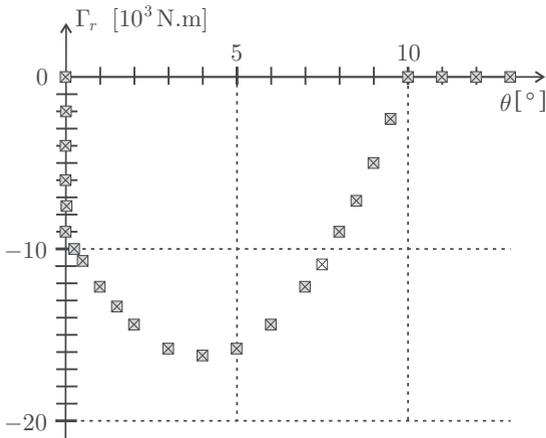
FIGURE 5 — Mesures du moment résistant. La taille des carrés représente l'incertitude de mesure.
