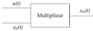
Figure 9 – Multiplication de l'onde porteuse et signal modulé
