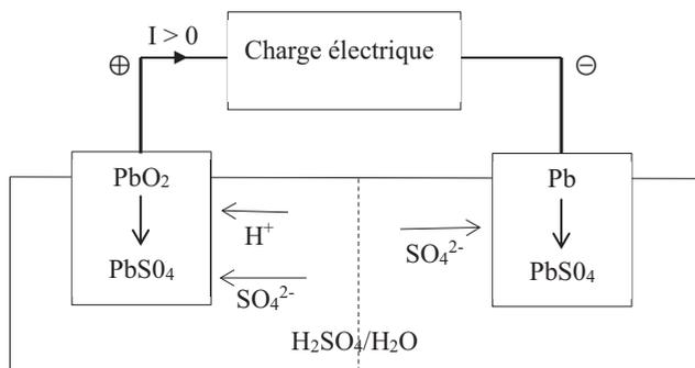
**Figure 4** – Accumulateur au plomb
