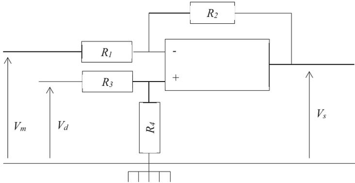
**Figure 11** – Montage du soustracteur
