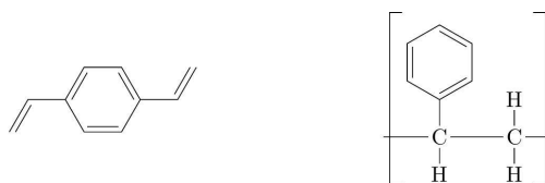
Figure 16 Formule du divinylbenzène et motif du polystyrène
