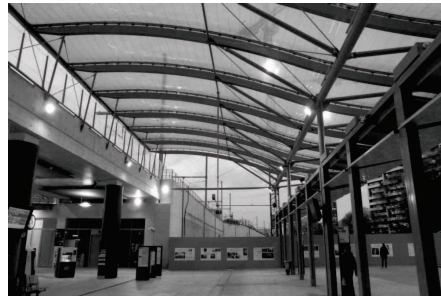
FIGURE 1 – Exemple de couverture en membrane ETFE.
