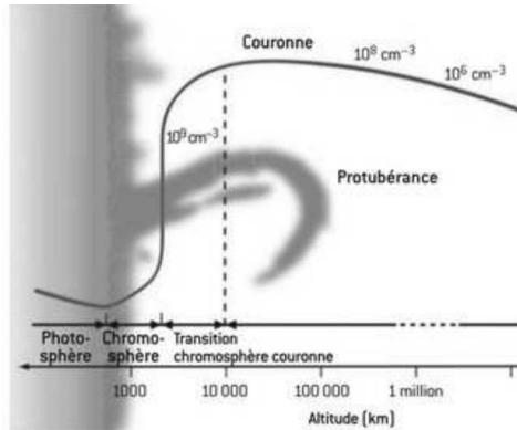
**Figure 2** Profil de température dans la couronne solaire : l'échelle de distance, logarithmique, montre la faible épaisseur sur laquelle se fait la transition entre la basse température de la photosphère et la haute température de la couronne. Des ordres de grandeur de densités volumiques de particules sont aussi indiqués.
