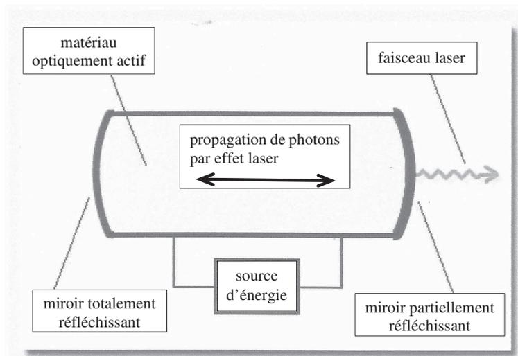
**Figure 11** - Schéma d'un dispositif laser
