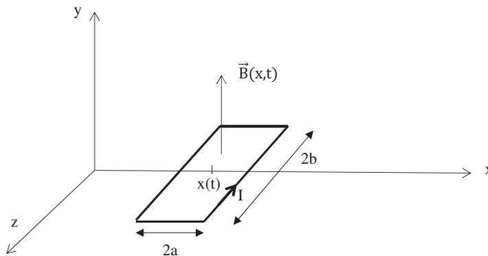
**Figure 5** - Actionneur linéaire synchrone
