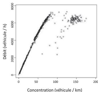
**Figure 2** – Points de mesure M8B : diagramme fondamental ( $c\_exp, q\_exp$ )
