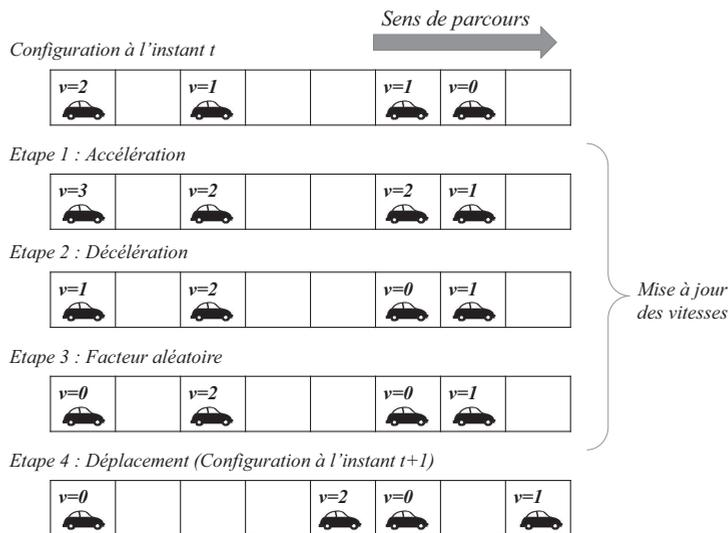
**Figure 8** – Illustration du schéma sur un exemple
