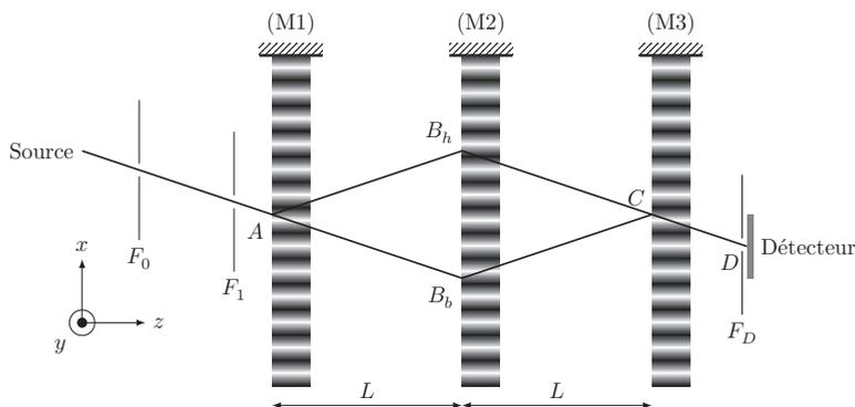
**Figure 1** Schéma de principe de l'interféromètre de Mach-Zehnder à ondes de matière (M1), (M2) et (M3) sont des miroirs plans ;  $F_0$  et  $F_1$  sont les fentes de collimation du jet supersonique ;  $F_D$  est la fente de détection ; la distance entre deux ondes stationnaires est  $L = 605$  mm
