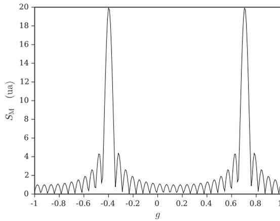
Figure 8 – Dépendance du maximum de la somme  $S_i(t)$  avec le glissement  $g_i$  pour  $f = 15$  kHz,  $N = 20$  et des transducteurs espacés de telle manière à former une antenne d'envergure  $L = 40 \times d$ .
