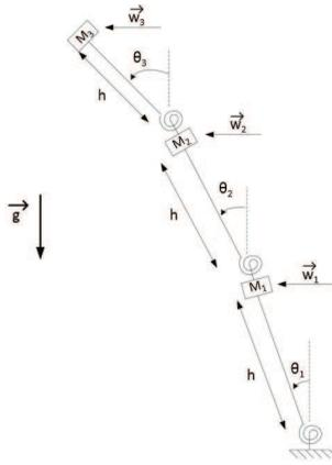
Figure 4 – Modèle de la tour à 3 degrés de liberté.
