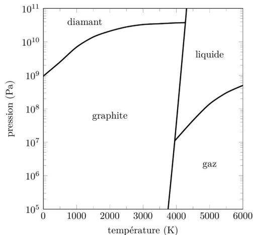
Figure 8 Diagramme de phases du carbone
