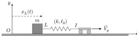
**Figure 3** Système modèle pour l'étude du mouvement stick-slip
