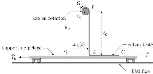
**Figure 2** Schéma du dispositif pratique utilisé pour l'essai de pelage. Le repère  $Oxy$  est lié au support de pelage. Les points  $I$  et  $L$  correspondent aux limites entre les parties collée et décollée du ruban
