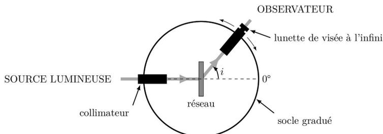
**Figure 2** Schéma du spectrogoniomètre (vue de dessus).
