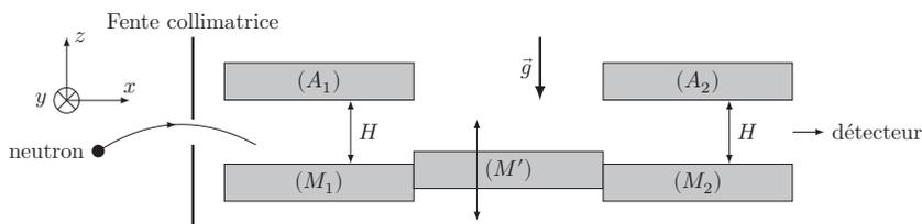
**Figure 5** Schéma du dispositif expérimental de l'expérience qBounce. D'après T. Jenke et al., Realization of gravity resonance spectroscopy technique, *Nature Physics* **7**, 468-472 (2011)
