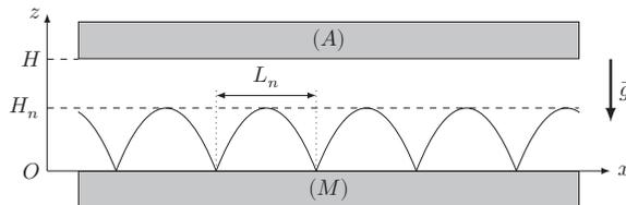
**Figure 7** Rebonds d'un neutron dans un guide
