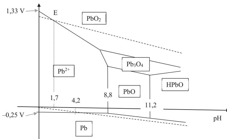
**Figure 5** - Diagramme potentiel-pH du plomb
