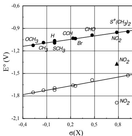
Figure 12 – Évolution de  $E_1^\circ(X)$  [●, ordonnée à l'origine :  $-1,08\text{ V}$ , pente :  $0,15\text{ V}$ ] et  $E_2^\circ(X)$  [○, ordonnée à l'origine :  $-1,70\text{ V}$ , pente :  $0,20\text{ V}$ ] en fonction des constantes  $\sigma(X)$  ; les substituants sont indiqués pour une seule série
