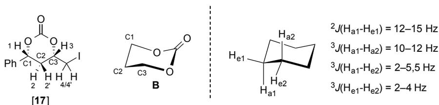
Figure 1 – Représentation du cycle **B** de [17] et valeurs représentatives des constantes de couplage entre des protons en position équatoriale/axiale portés par le même carbone ( $^2J$ ) ou par deux carbones voisins ( $^3J$ ) sur un cyclohexane en conformation chaise.
