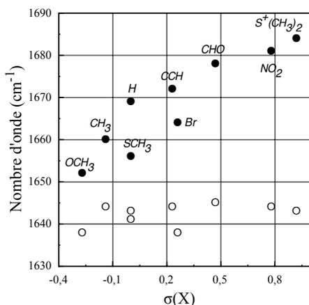
Figure 11 – Variation des nombres d'onde de vibration infrarouge des fonctions  $N^+-CH_3$  et  $C=O$  dans  $[8-X]^+$  en fonction des constantes  $\sigma(X)$  ; les substituants sont indiqués pour une seule série
