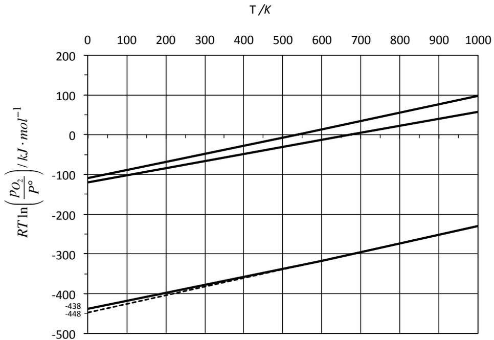
6- En utilisant le diagramme, estimer, en expliquant la méthode, la valeur de l'enthalpie standard de fusion du plomb (température de fusion  $T_f = 600$  K).
