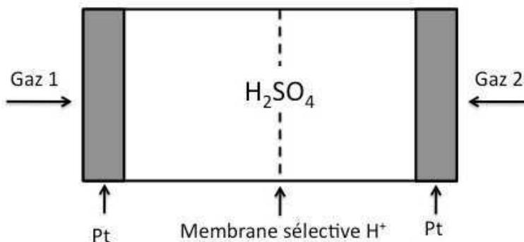
Figure A3 : Schéma de la pile à combustible
