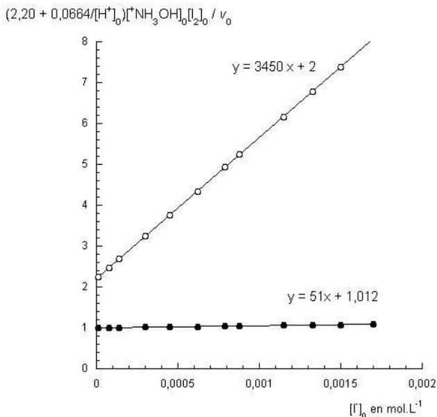
Figure A6 : Dépendance du rapport  $\left(2,20 + \frac{0,0664}{[H^+]_0}\right) \frac{[{}^+NH_3OH]_0[I_2]_0}{v_0}$  en fonction de la concentration initiale en ions iodure. Les expériences sont réalisées à 25°C dans les conditions  $[I_2]_0 = 6,2 \cdot 10^{-4} \text{ mol.L}^{-1}$ ,  $[{}^+NH_3OH]_0 = 3,1 \cdot 10^{-2} \text{ mol.L}^{-1}$ , ● :  $[H^+]_0 = 10^{-3} \text{ mol.L}^{-1}$  ; ○ :  $[H^+]_0 = 10^{-1} \text{ mol.L}^{-1}$
