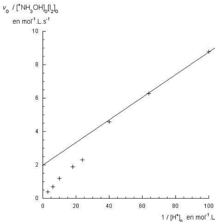
Figure A5 Influence de la concentration en ions hydronium sur la vitesse initiale de la réaction. Les expériences sont réalisées à 25°C dans les conditions  $[I_2]_0 = 5,5 \cdot 10^{-4} \text{ mol.L}^{-1}$ ,  $[^+NH_3OH]_0 = 2,8 \cdot 10^{-2} \text{ mol.L}^{-1}$ ,  $[I^-]_0 = 3,5 \cdot 10^{-6} \text{ mol.L}^{-1}$ .
