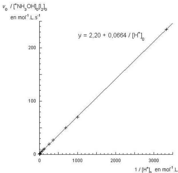
Figure A4 : Influence de la concentration en ions hydronium sur la vitesse initiale de la réaction.  $v_0$  est la vitesse initiale de disparition du diiode. Les expériences sont réalisées à 25°C dans les conditions :
