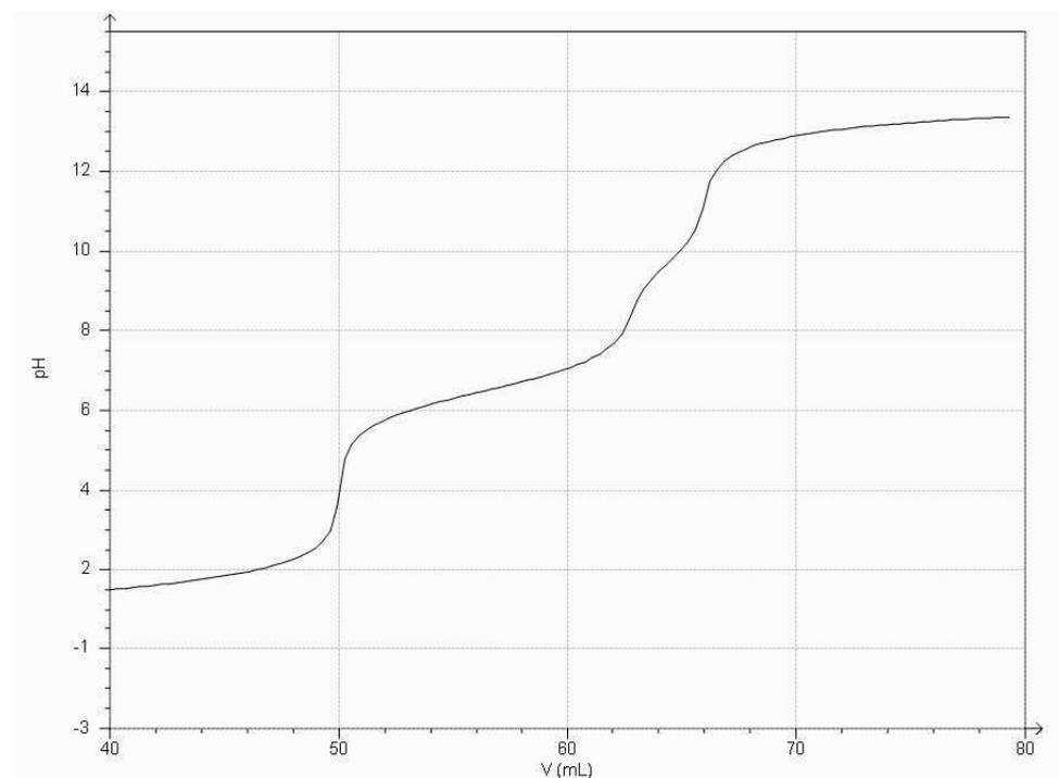
Figure A2 - Dosage de  $10,0\text{ mL}$  de la solution électrolytique par une solution d'hydroxyde de sodium de concentration  $0,500\text{ mol}\cdot\text{L}^{-1}$ .
