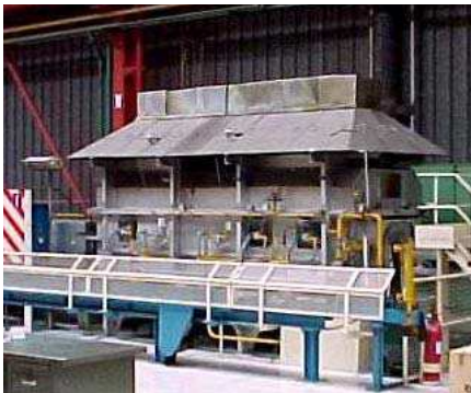
Figure 1 : exemple de four industriel (à gauche), qui intervient dans la fabrication de tubes (à droite), en nickel, pour un générateur de vapeur d'une centrale nucléaire.
