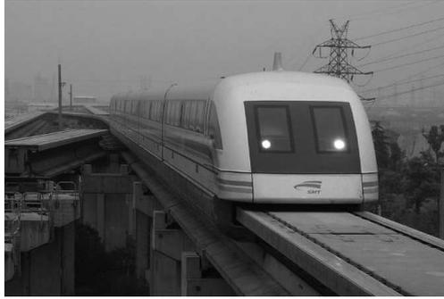
Figure 11 : Train à technologie EMS (Chine).
