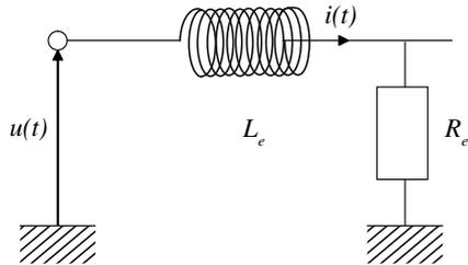
Figure 8 : Schéma électrique de l'actionneur.
