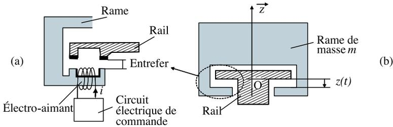
Le système de suspension (figure 6a) est constitué d'un électro-aimant solidaire de la rame du train. La culasse de l'électro-aimant (en forme de U) est entourée d'une bobine de  $N$  spires. L'enroulement est parcouru par un courant variable, noté  $i$ , ce qui génère une force électromagnétique dans l'entrefer. Un circuit électrique réalise l'asservissement de la position relative train/rail (entrefer) à une valeur constante, en régulant le courant qui parcourt la bobine.
