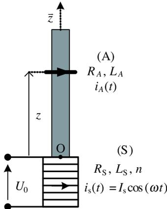
Figure 2 : Une réalisation de l'expérience d'Elihu Thomson
