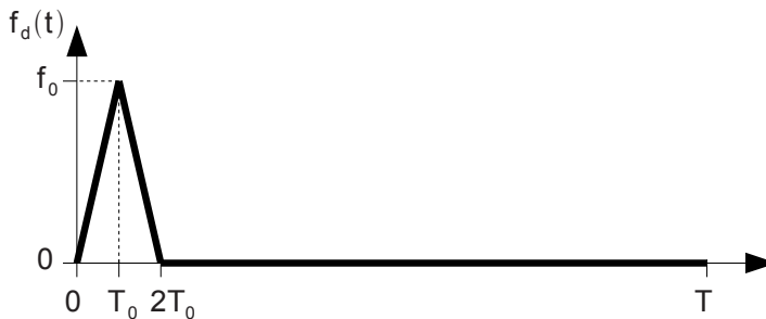
Figure 14 : modélisation adoptée pour la force créée par l'explosion du cordon pyrotechnique.
