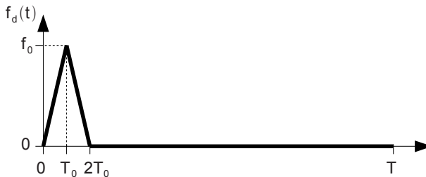
Figure 24 : modélisation adoptée pour la force créée par l'explosion du cordon pyrotechnique.
