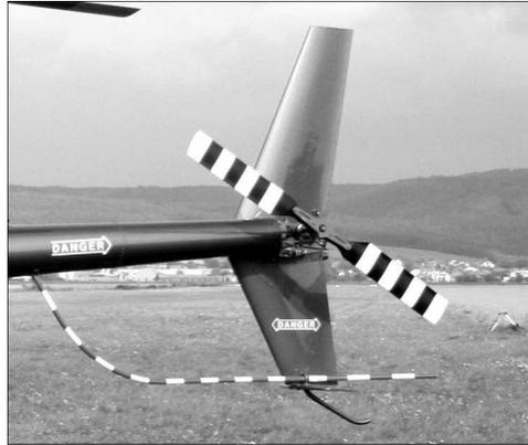
Figure 6 - Rotor anticouple d'un hélicoptère *Robinson R44*.
