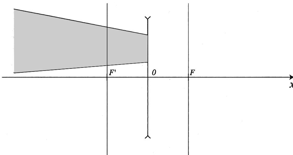
Figure 1 : faisceau convergent arrivant sur une lentille divergente
