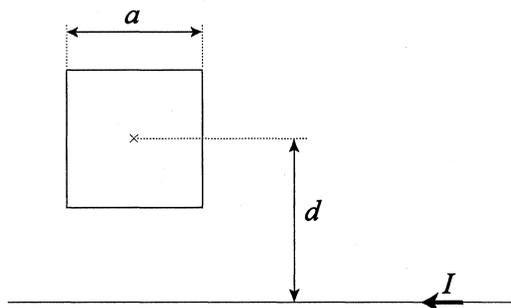
Figure 4 : schéma d'un anneau couplé au résonateur
