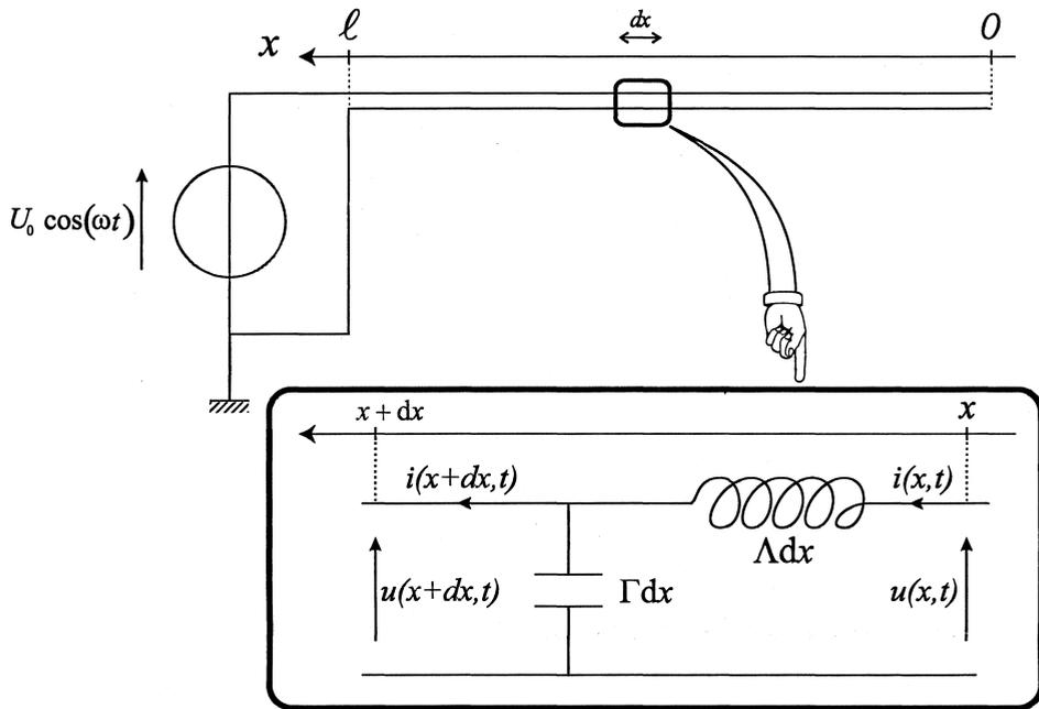
Figure 2 : ligne bifilaire et portion de largeur  $dx$
