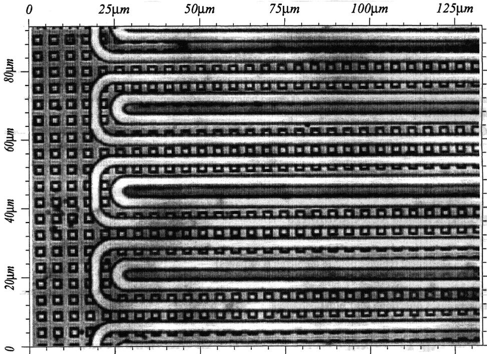
Figure 1 : microphotographie optique d'une partie de la ligne bifilaire en méandre et de ses anneaux mésoscopiques carrés.
