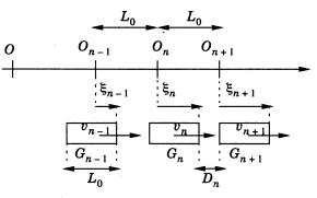
les vont ainsi être considérés comme une chaîne infinie d'oscillateurs couplés. Les voitures sont numérotés par le nombre entier n. On repère la position  $G_n$  de l'avant du véhicule n par rapport au point  $O_n$ , où  $OO_n = nL_0$ . Les points  $O_n$  sont ainsi régulièrement espacés d'une distance  $L_0$  et lorsque les  $G_n$  sont confondus avec les  $O_n$ , toutes les voitures sont pare-chocs contre pare-chocs. On note  $\xi_n = O_n G_n$  (algébrique).
