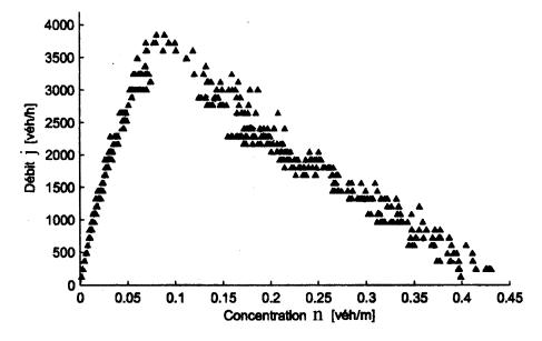
(d'après la thèse de L. Leclercq « Modélisation dynamique du trafic et applications à l'estimation du bruit routier » [2002]), réalisé en ville où la vitesse est limitée à 50 km/h sur une portion de route à une seule voie sans aucun obstacle sur plusieurs centaines de mètres. Ce modèle tient compte de la présence des deux-roues dans le trafic routier.
