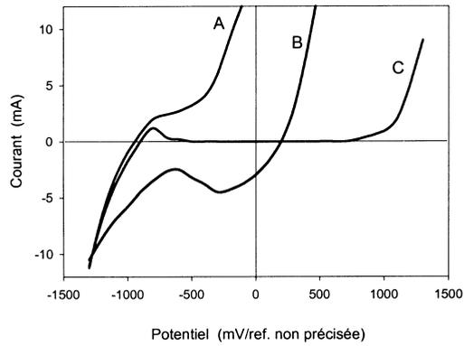
**Fig. 3 :** Courbes intensité-potentiel à 25°C (électrolyte  $\text{Na}_2\text{SO}_4$  0,01 mol.L<sup>-1</sup>).
