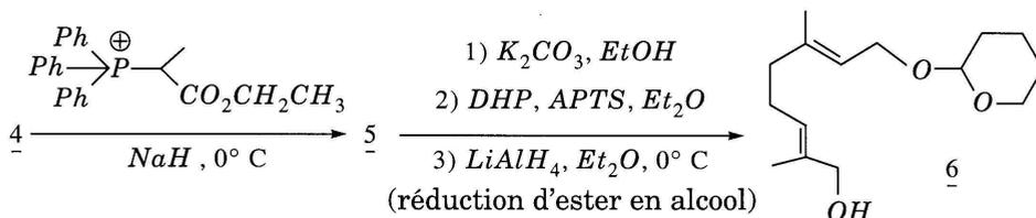
L'*APTS* est l'acide paratoluène sulfonique, acide donneur de protons en milieu organique. Le spectre de  $RMN^1H$  du *DHP* a été enregistré dans  $CDCl_3$  à une fréquence de 400 MHz. Les déplacements chimiques sont donnés par rapport au tétraméthylsilane (*TMS*). Ce spectre est donné à la figure 4 (en annexe).
