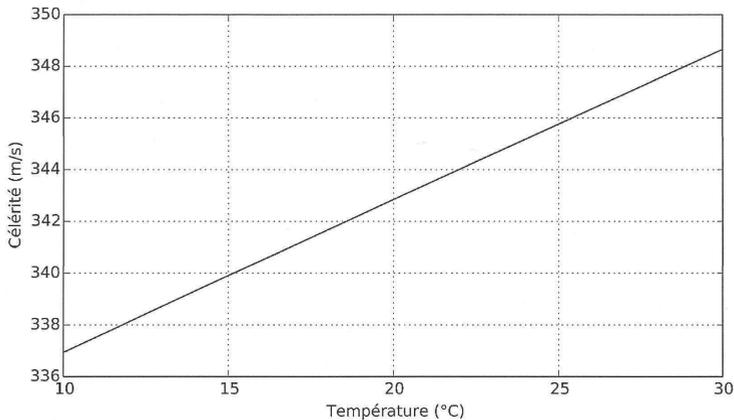
**Figure 2** – Célérité des ultrasons en fonction la température
