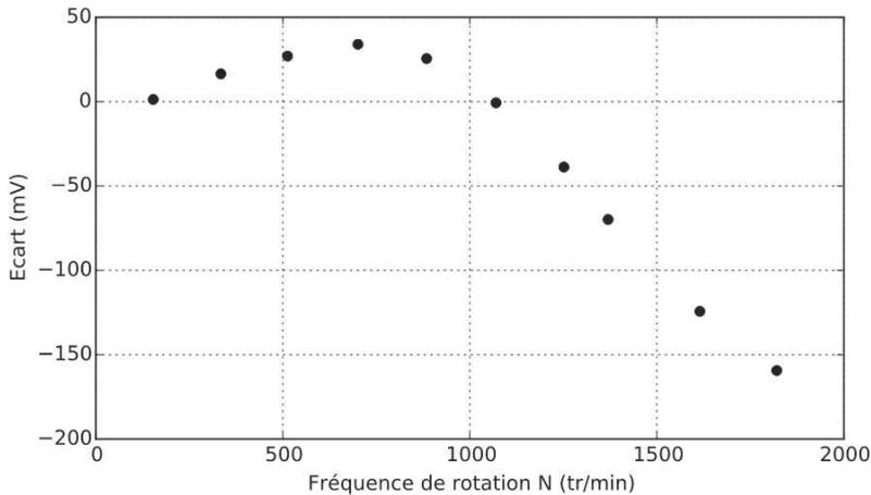
**Figure 14** – Écart  $\varepsilon_k = E_k - \phi \Omega_k$  pour chaque mesure
