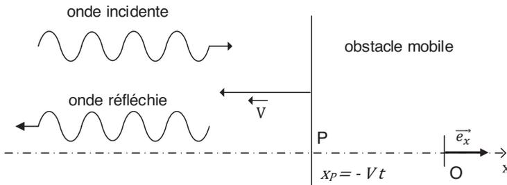
**Figure 7** – Réflexion sur une interface plane mobile
