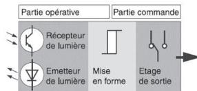
**Principe d'un détecteur photoélectrique**
