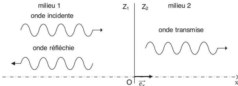
**Figure 4** – Réflexion et transmission sur une interface plane
