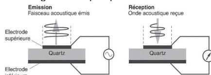
**Principe d'un transducteur électroacoustique**
