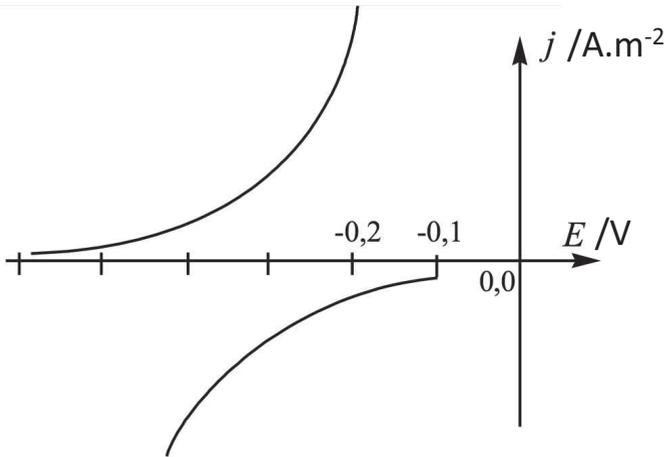
**19-** Reproduire la figure et associer à chaque courbe le phénomène correspondant. Justifier notamment par l'écriture de demi-équations d'oxydoréduction. Faire figurer la position du potentiel de corrosion  $E_{cor}$  et de la densité de courant de corrosion  $j_{cor}$ .
