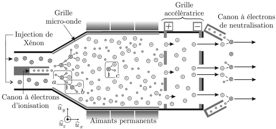
FIGURE 2 — Représentation schématique du moteur ionique : les symboles  $\odot$  sont des atomes de Xénon,  $\oplus$  des ions  $Xe^+$  et  $\circ$  des électrons.
