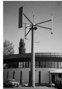
FIGURE 1 – Eolienne de type Darrieus.
