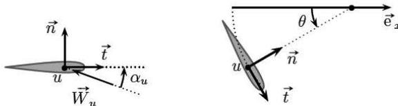
FIGURE 5 — Schéma de la pale et du repère  $(u, \vec{t}, \vec{n})$  solide de la pale. La vitesse relative du vent  $\vec{W}_u$  dans ce référentiel définit l'angle orienté  $\alpha_u = (-\vec{W}_u, \vec{t})$ . Le sens positif est le sens trigonométrique (l'angle  $\alpha_u$  est donc positif dans la situation représentée).
