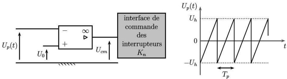
FIGURE 7 – Circuit générant la tension  $U_{cm}(t)$ .
