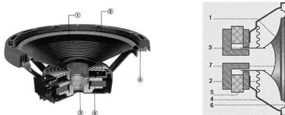
FIGURE 1 – Vue en coupe et schéma de haut-parleur. 1 Membrane. 2 Suspension de centrage. 3 Bobine. 4 Saladier. 5 Aimant. 6 Suspension. 7 Cache-Poussière. Source : http://autoson.fr/hp.php .
