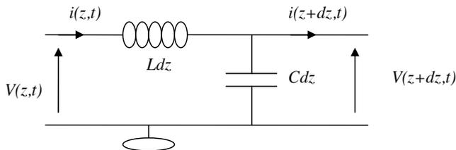
Figure 2 : Modèle bifilaire d'une portion de câble
