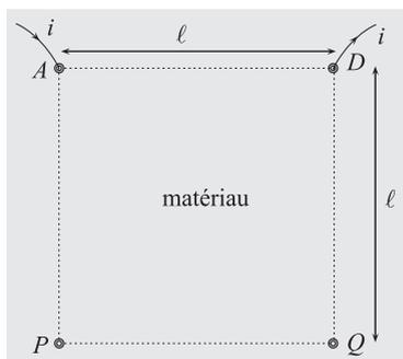
FIG. 2 – Géométrie de van der Pauw : les points  $A$ ,  $P$ ,  $Q$  et  $D$  forment dans cet ordre un carré.
