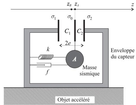
FIG. 3 – Schéma de l'accéléromètre
