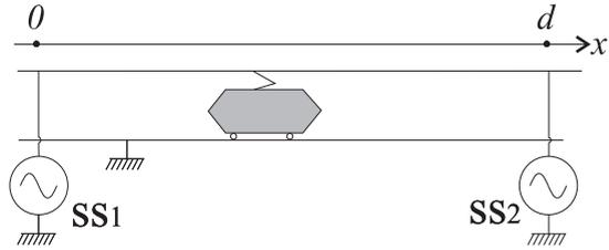
FIG. 1 – Schéma d'alimentation du TGV
