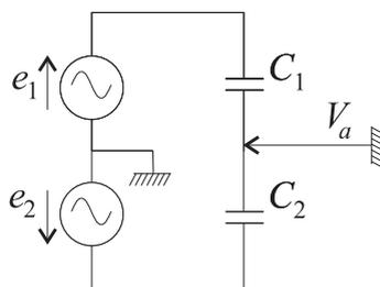
FIG. 4 – Schéma équivalent du capteur
