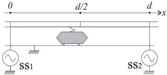
FIG. 2 – Alimentation avec feeder
