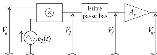
FIG. 5 – Traitement du signal du capteur
