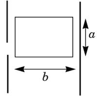
III.C.1) À partir des résultats de la section précédente et en supposant que  $b \gg a$ , calculer l'inductance  $L_1$  de la boucle (on supposera que la perméabilité magnétique du macadam peut être assimilée à celle du vide).
