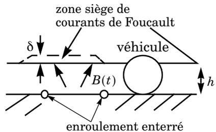
de cette section est de quantifier cette variation d'inductance ainsi que l'augmentation de la résistance due aux pertes par effet Joule dans la carcasse métallique. Sauf avis contraire, on se place dans le cas où la boucle enterrée n'est constituée que d'un seul enroulement ( $N = 1$ ).
