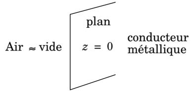
Ce champ pénètre dans le conducteur métallique et donne naissance, pour  $z > 0$ , à une onde dont le champ magnétique est de la forme  $\vec{B}_0 e^{-z/\delta} \cos(\omega t - k'z + \phi_B)$  (cf. question II.B.4).
