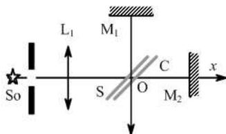
Fig. 4 : Interféromètre de Michelson.
