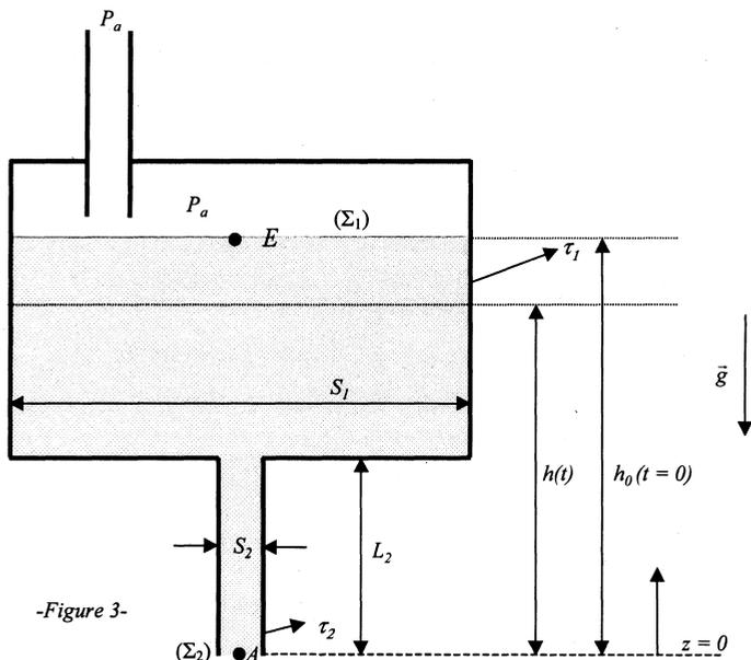
La surface libre du réservoir est maintenant directement reliée à l'atmosphère (voir figure 3). La vanne  $EV_2$  est ouverte et le régime permanent est supposé atteint instantanément. Le volume instantané de fluide contenu dans le réservoir est désigné par  $\tau_1$ , et celui contenu dans le tube de vidange de longueur  $L_2$  par  $\tau_2$ . On supposera de plus que  $S_1 \gg S_2$ .
