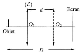
3. — La lentille précédente est remplacée par une lentille convergente  $\mathcal{L}'$  de distance focale image  $f'$  inconnue. Les deux positions de la lentille qui donnent une image nette sur l'écran sont séparées par une distance  $d' = 600$  mm. Calculer  $f'$ .
