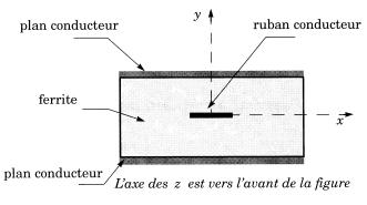
Ce type de dispositif est utilisé dans les liaisons hyperfréquence à basse puissance. On néglige la résistance des conducteurs et on suppose que la ferrite présente une conductivité faible.
