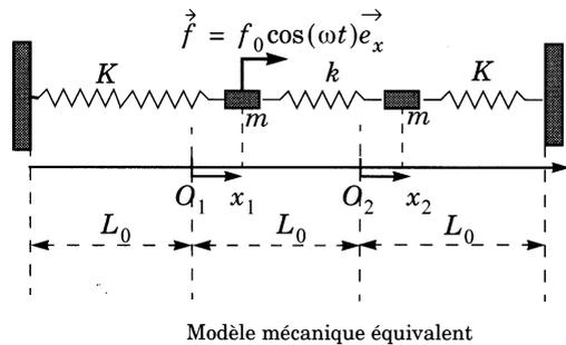
Un modèle mécanique équivalent, résumé dans le tableau ci-dessous, permet d'en comprendre l'idée maîtresse. Sur le schéma équivalent, les positions d'équilibre sont notées  $O_1$  et  $O_2$ .
